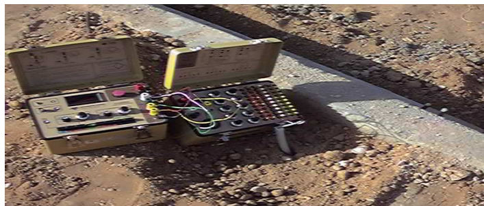
Photo n° 6 : Pont extensométrique du type P3500.
